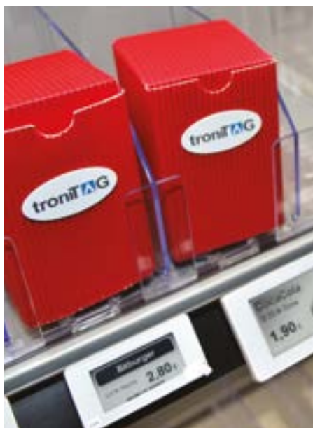
Bezdrátově řízené elektronické cenovky - Electronic Shelf Labels (ESL) Tronitag.
