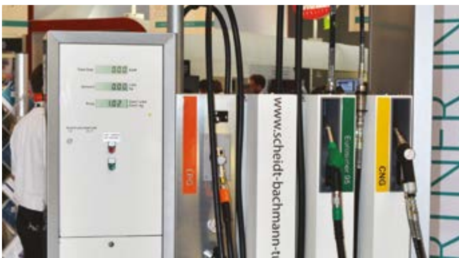
Trendem v konstrukci stojanů je heslo All in One, založené na vysoké míře modularity umožňující kombinaci výdeje klasických paliv, plyných CNG a LPG či výdeje AdBlue a popřípadě kapalin do oštríkovaců.
