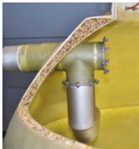
ORL Haase s dvouplošnou sklolaminátovou jímkou s porézní výplní meziprostoru drobnými oblázky vázanými pryskyřicí.
