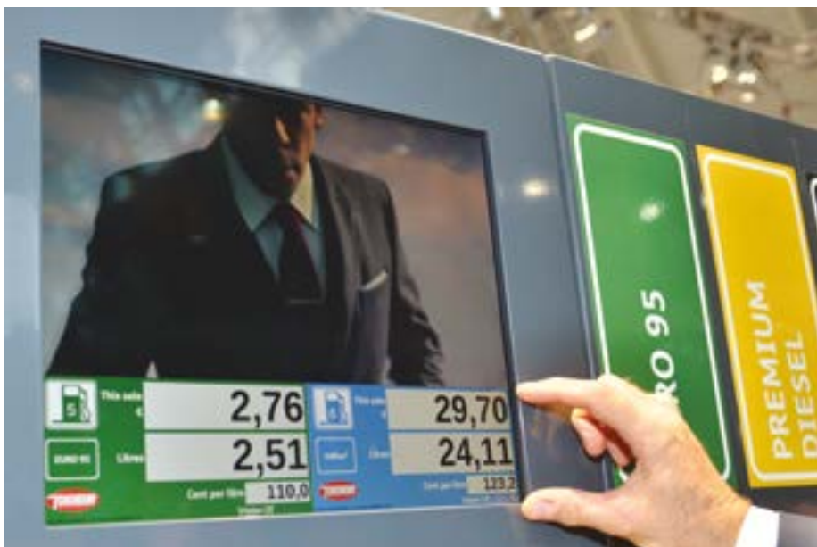
Sdružení multimediálního obsahu (například reklamy) s údaji o probíhajícím tankování na jediné obrazovce (Tokheim).
