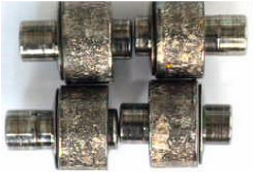
Poškodenie vstrekovacieho čerpadla, nízka mazivosť paliva
