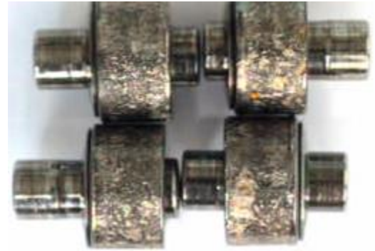
Poškodenie vstrekovacieho čerpadla, nízka mazivosť paliva
